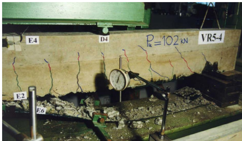
Figura 8. Ruptura por descolamento na viga reforçada com quatro lâminas de PRFC. Fonte: Beber [3].
