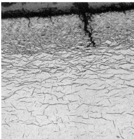
Figura 9 – Micrografia de um dano causado pela formação de hidretos em uma amostra de titânio [17].
