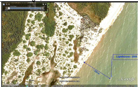
Figura 12. Farol em 26/02/2004 a 235 m ao largo (Altitude de visão = 873 m). [10]
