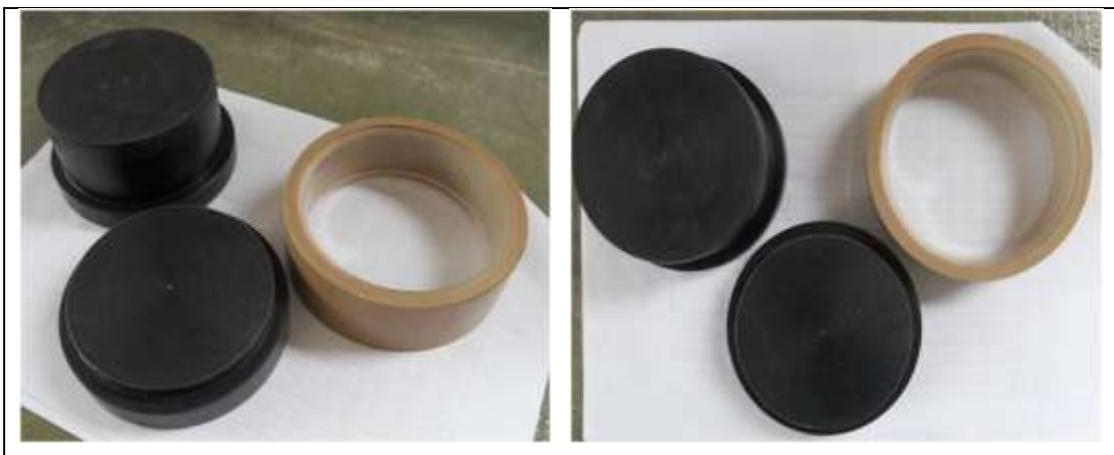
Figura 12: Aparato empregado para compactação dos corpos de prova.
