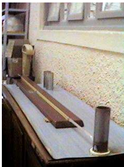
FOTO 4 – Ensaio de infiltrabilidade pela metodologia MCT
