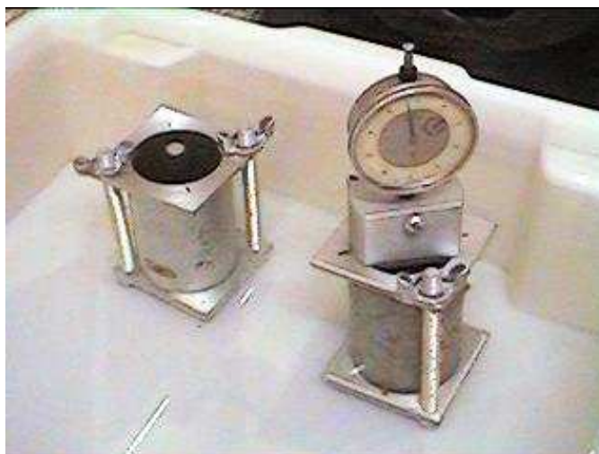
FOTO 2 – Medida da expansão sob imersão no ensaio mini-CBR
