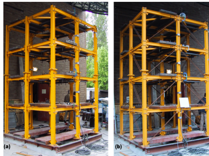
Figura 3: “Yellow Frame” (a) sem contraventamentos e (b) com contraventamentos. [8]
