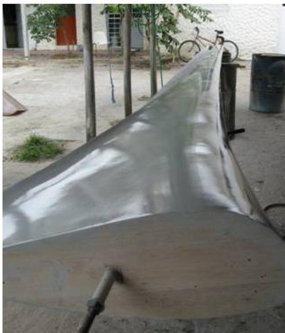
Figura 9 - Modelo da Pá Pintado com Duas Mãos de Tinta Poliuretano (Pinho et al., 2009).
