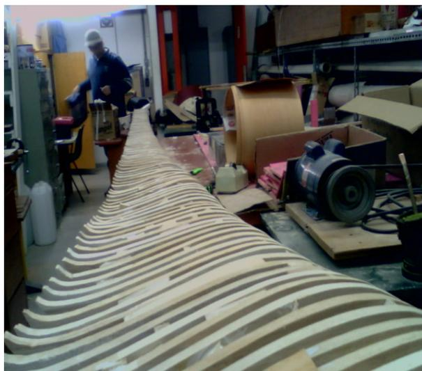
Figura 8 - Perfis da pá construído em madeira balsa (Corrêa et al., 2007).
