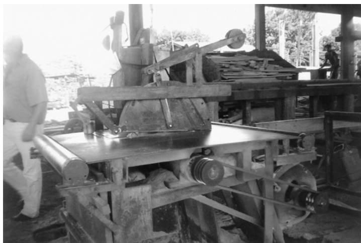
FIGURA 4 - EPC na serra circular, e em falta no conjunto correia-polia.
