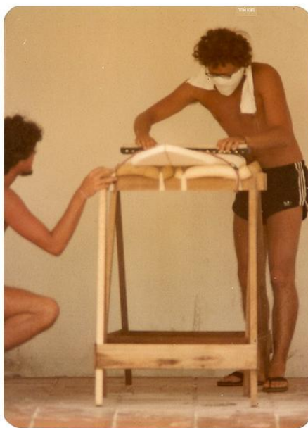
Imagem 3: Acima temos Renato ajoelhado, segurando os cavaletes, e Ramiro em pé lixando o bloco de poliuretano (foto cedida por Ramiro em outubro de 2010).
